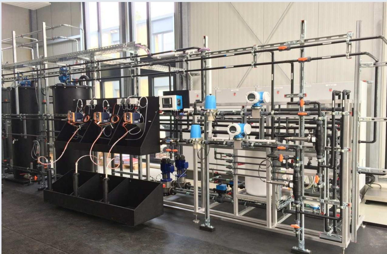
Neubau einer zweistrassigen Sickerwasseraufbereitung im Technikumsmaßstab als Abbildung der vorhandenen Aufbereitungsanlage. Umfangreiche messtechnische Ausstattung der biologischen Stufe und der Ultrafiltration zur Einstellung und Erfassung unterschiedlicher Verfahrensabläufe.
